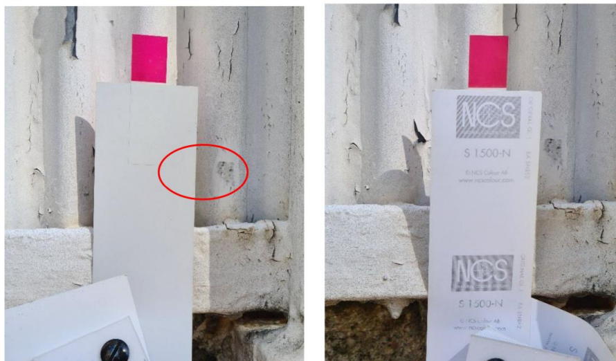
Den ursprungliga brutet vita kulör som mätts in. Samtliga, tidigare lätt gråvita balkongtom, har senare målats i renare vit kulör.
